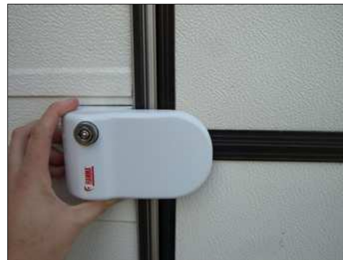
dann lieber hier über dem Trennungspalt der Aufbautür
